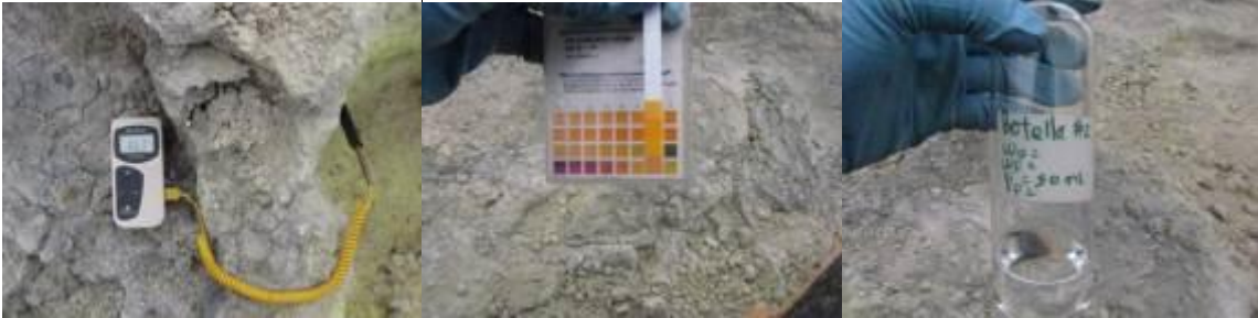
Figura 103. Muestreo de gases de origen volcánico, Temperatura, pH, botella Giggenbach-Domo Mallama, volcán Azufral.
